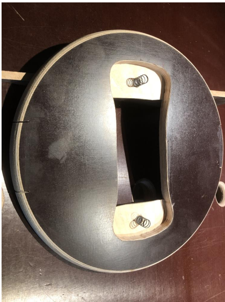
Den Rest bis auf ca.3 mm mit der Fräse entfernen
