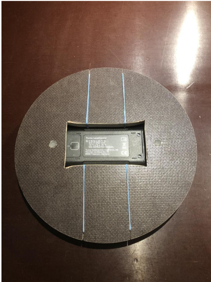
Optional: für ein Gummiband Kerben einsägen.
