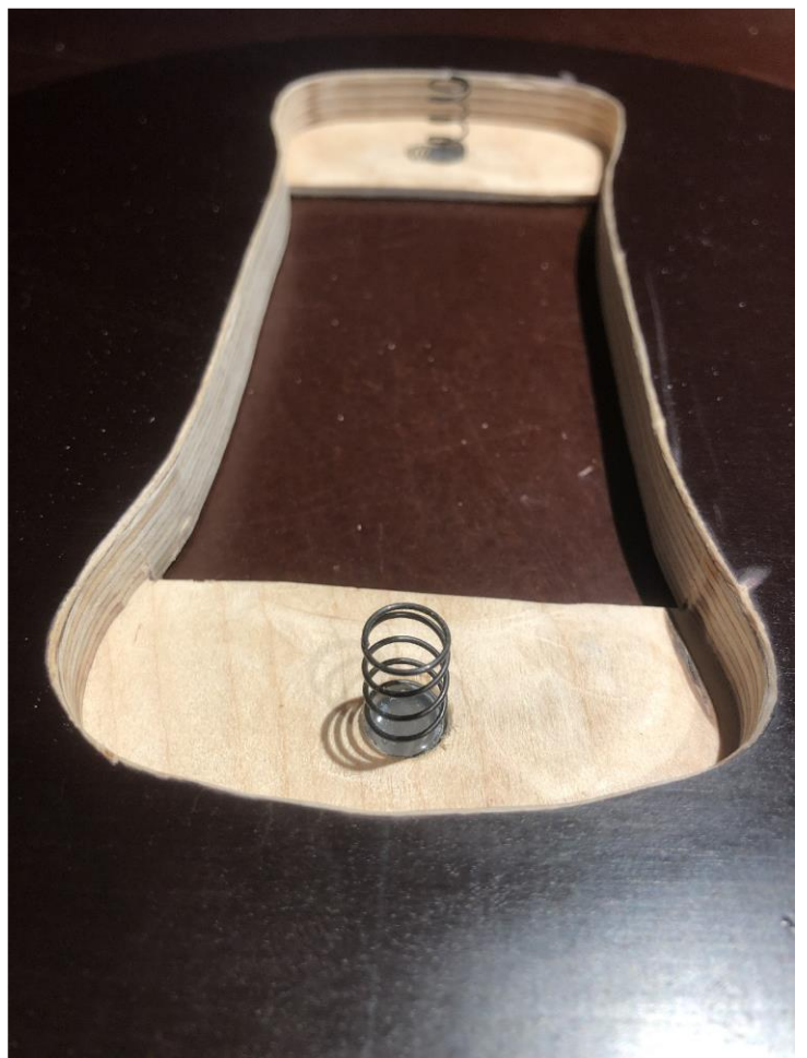
Federbreite durchbohren und mit Heißkleber fixieren.
