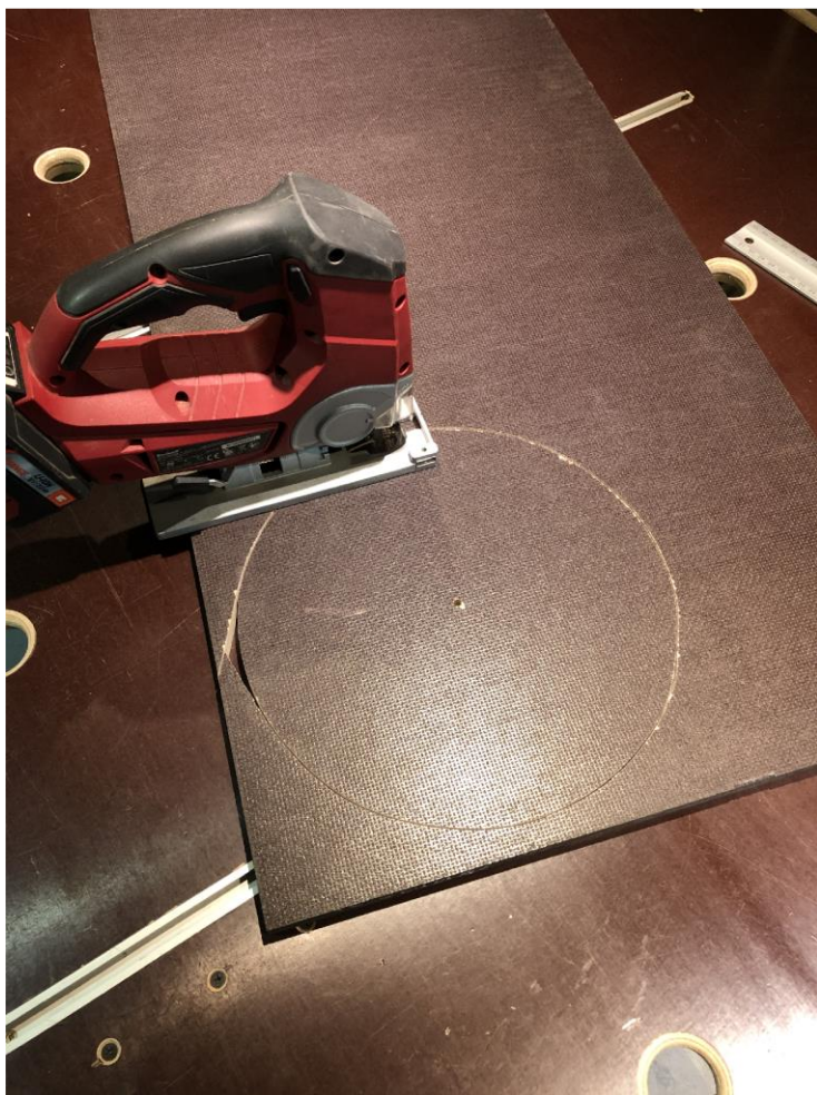
Mit der Stichsäge einen Durchmesser von ca. 26,5 cm aussägen.
