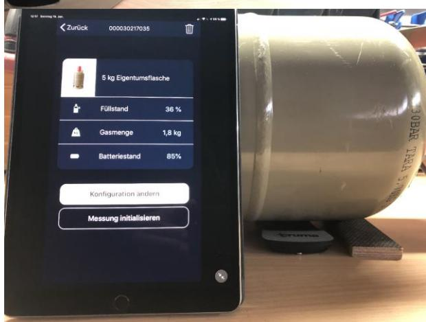
2. Messung der liegenden 5 kg Gasflasche mit der Standardkonfiguration für 5 kg Gasflaschen.
