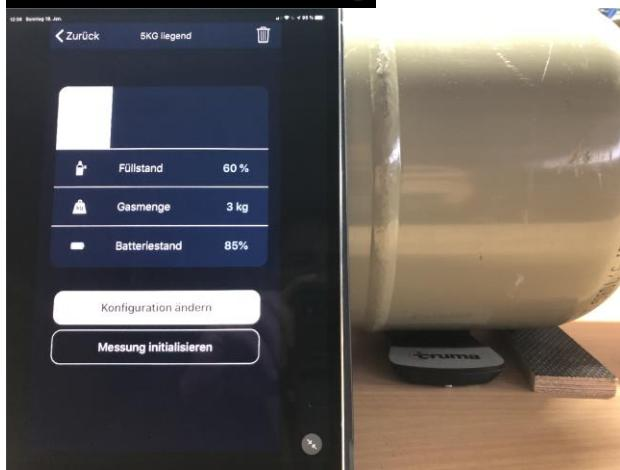
4. Messung der liegenden 5 kg Gasflasche mit eigener Konfiguration.
