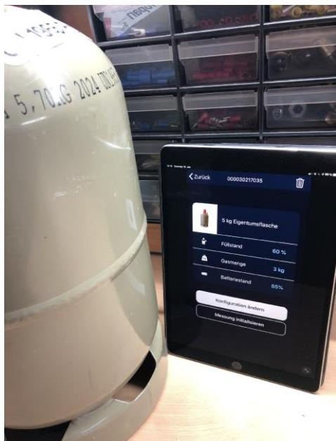
1. Messung der stehenden 5 kg Gasflasche mit der Standardkonfiguration für 5 kg Gasflaschen.
