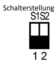
Auch zu verwenden bei Angabe „Charge Voltage: 14,6 V“, da geringere Batteriebelastung.
