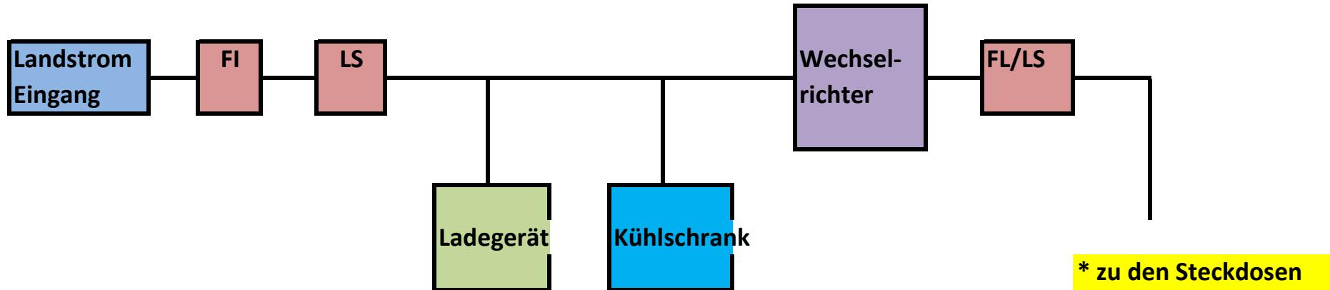
Ladegerät und Kühlschrank sind ausgeschleift damit diese Geräte nur bei Landstromanschluss mit 230 V versorgt werden
