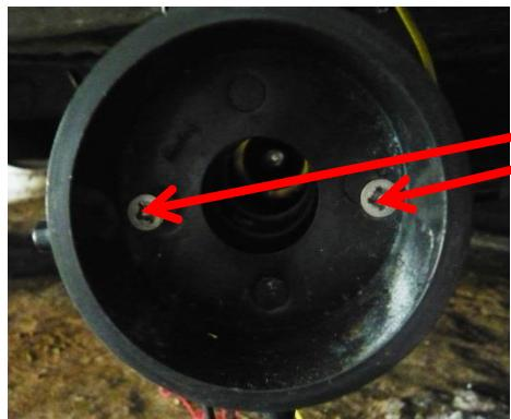
Abwasserrohr vorne, 2 Schrauben lösen
