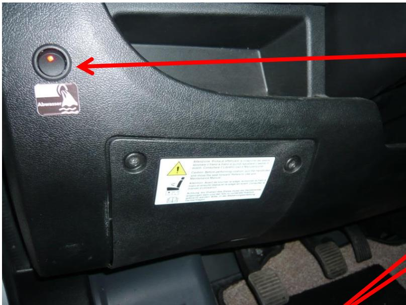
20mm Loch bohren für LED Schalter
