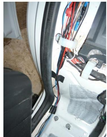
Plastikstopfen heraus nehmen und Loch seitlich vergrößern, Kabel durchziehen (das blaue Kabel ist für den Motorkugelhahn, die anderen für die Rückfahrkamera und Abwasserkamera)
