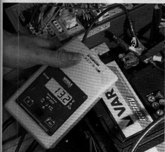
Ohne Booster kommt von der Lichtmaschine am Bordakku nur eine Ladespannung von 13,2 Volt an.
