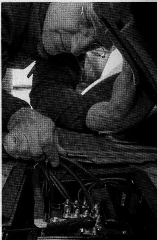
Auf Aufstelldächern lassen sich Solarpaneele nur schwierig verkabeln. Ein Booster kann eine Alternative sein.
