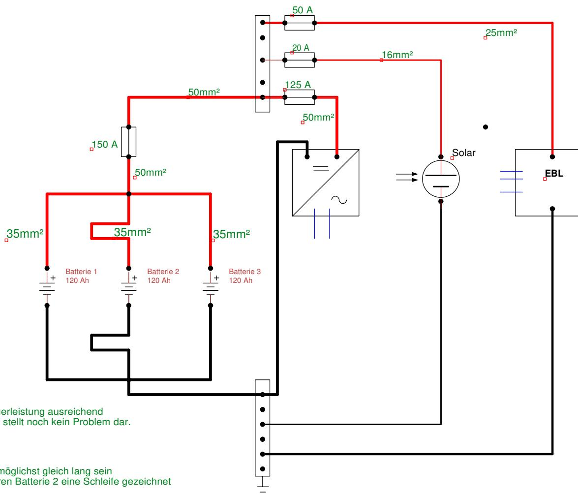
Der Kabelquerschnitt 50 mm<sup>2</sup> ist für 1.500 W Dauerleistung ausreichend und auch eine kurzzeitige Belastung mit 2.000 W stellt noch kein Problem dar.
